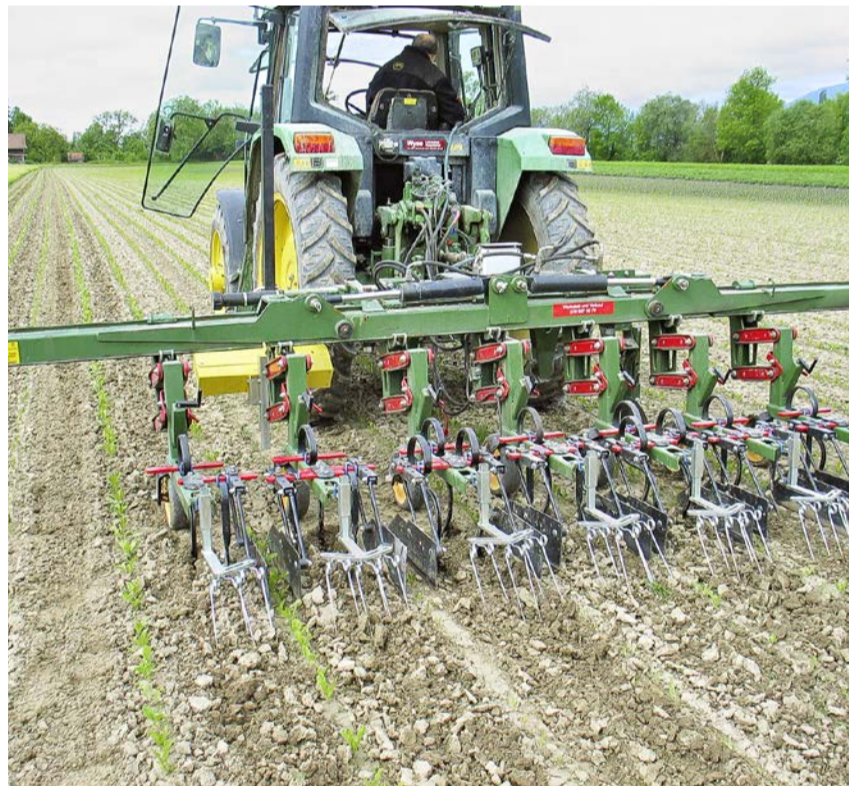
Kameragesteuerte Hacke im Zuckerrübenanbau. Bild: Hansueli Dierauer, FiBL
