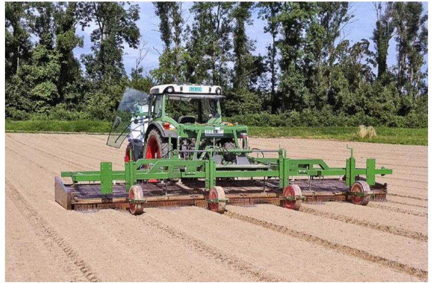
Abflamngerät mit Flüssiggas im Fronttank. (Bild: © Heinz Höneisen)
