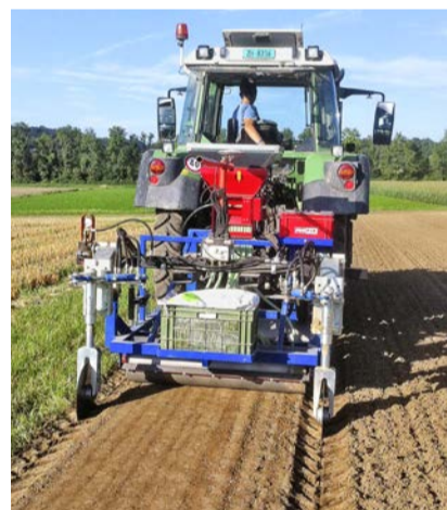
GPS-gesteuerter Traktor und GPS-gesteuerte Sämaschine, gesteuert mit Scheibensechen. (Bild: © Heinz Höneisen)
