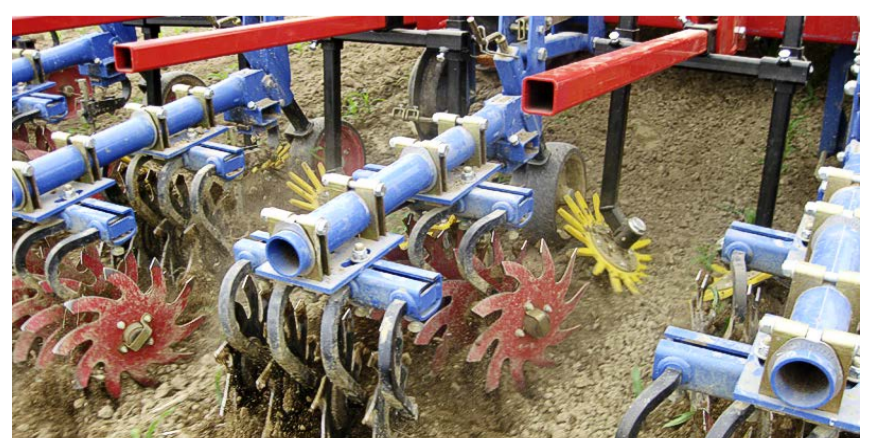
Die Sternhacke kann beim Weghäufeln mit der Fingerhacke kombiniert werden. (Foto: © Hatzenbichler, Firmenfoto)
