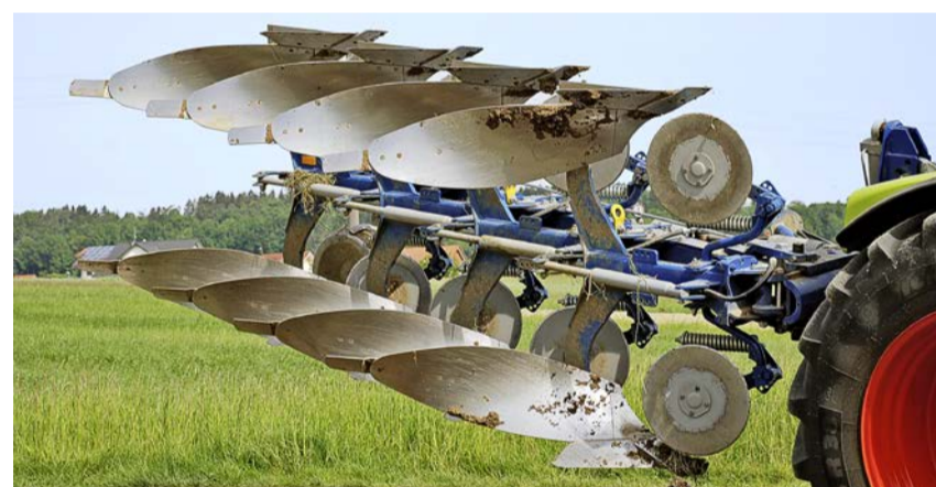
Ideal für das flache Pflügen sind Pflugkörper mit langen und stark gewundenen Streichblechen, die die Fuhre vollständig wenden können. Der Anstellwinkel der Scharen sollte nicht zu steil sein und der Meissel sollte einen guten Einzug gewährleisten. Im Bild der Pflug von Överum. (Foto: © FiBL, Deborah Rentsch)
