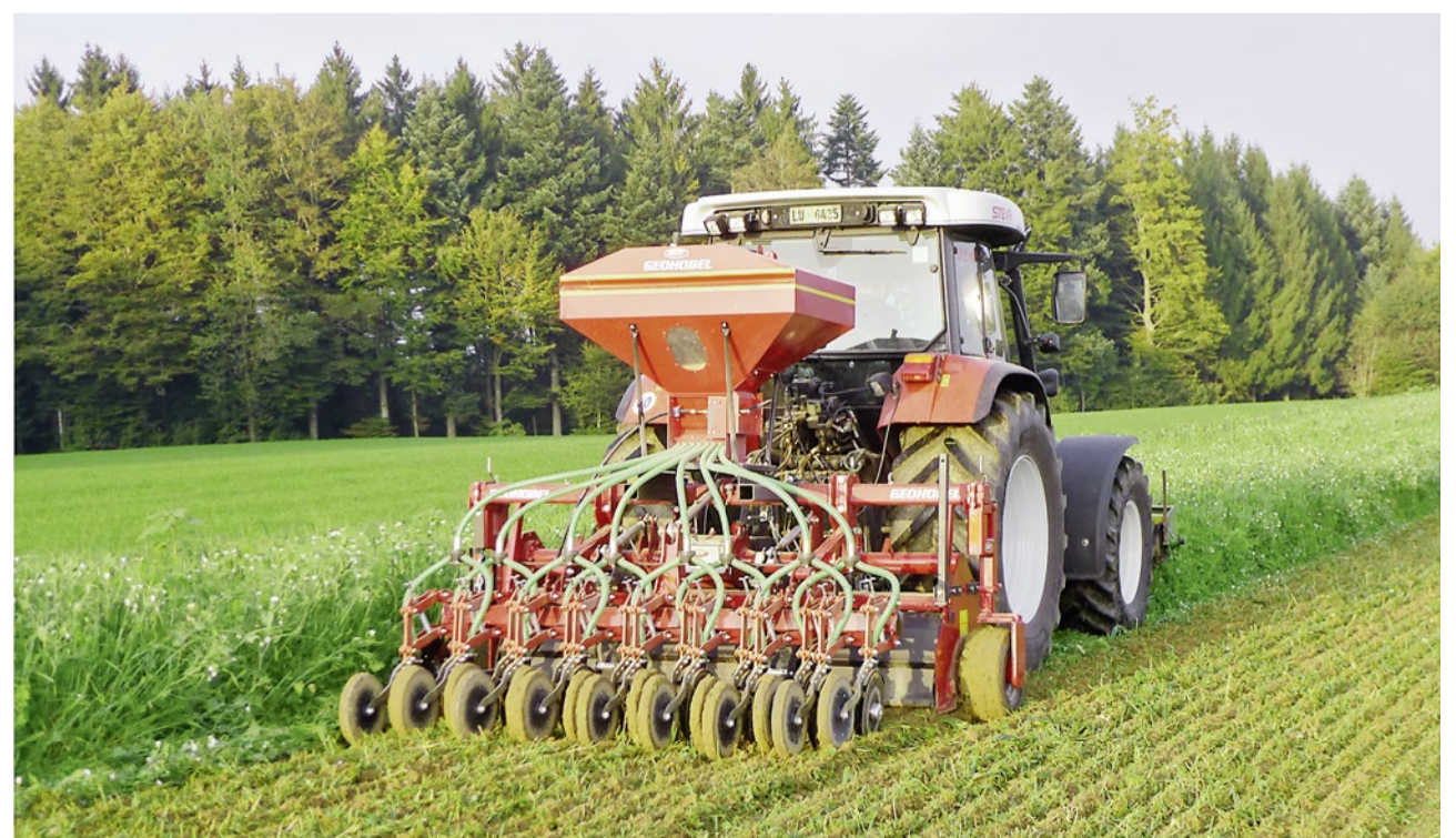
Geohobel: Einarbeiten von, speziell auf den Boden bzw. auf die nächste Hauptfrucht abgestimmten «Mischgemenge», mit gleichzeitiger Einsaat. copyright © 2014 rath-maschinen.com
