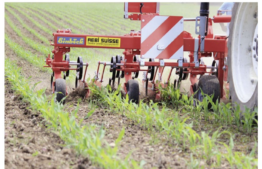
Einbäck Reihenhackgerät CHOPSTAR mit automatischer Oberlenkerlenkung. GPS und Kamera gesteuerte Hackgeräte zur Unkrautregulierung sind an der Maschinen-demo vorgestellt worden. (Bild: Tatjana Hans)
